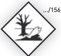
zusätzliche Kennzeichnung für umweltgefährdende Stoffe [Anpassung der Gestaltung ist auf Grund von Änderungen in den Vorschriften möglich.]
