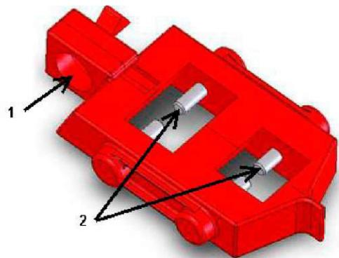
*Hinweis: Stellen Sie sicher, dass die Lockout-Vorrichtung sicher am Schutzschalter angebracht ist und sich nicht bewegen lässt.*
